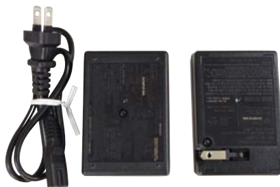
軽量化を図った電源コード。左が従来品、右がプラグイン化した現行品
